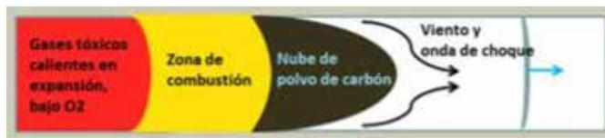
Figura 1. Ejemplo de las zonas que se identifican en una explosión. Tomado de la referencia [1]
