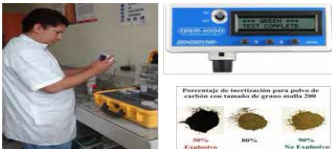
CDEM - 1000 (Coal Dust Explosibility Meter, ver Figura 7). Con este equipo se encuentran las proporciones entre la mezcla de polvo de roca y polvo de carbón, para las cuales el polvo de carbón deja de ser explosivo por exceso de material incombustible. Las inertizaciones son para realizarlas bien, no por aparentar.
